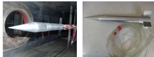
شکل ۱۰- مدل مونتاژ شده و نمایش آن در محفظه تست تونل باد
