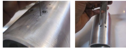
شکل ۸- نصب نازل‌ها به صورت موازی باهم روی بدنه و نمایش موقعیت حسگرها روی بدنه و در اطراف جت (سمت چپ)
