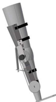
شکل ۶- مدل سه بعدی از طرح اورتز پیشنهادی
