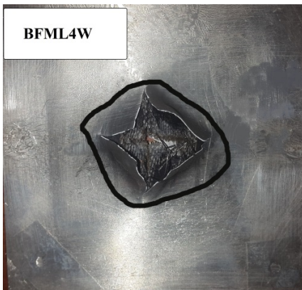
شکل ۱۱- مساحت تخریب نمونه BFML4W
