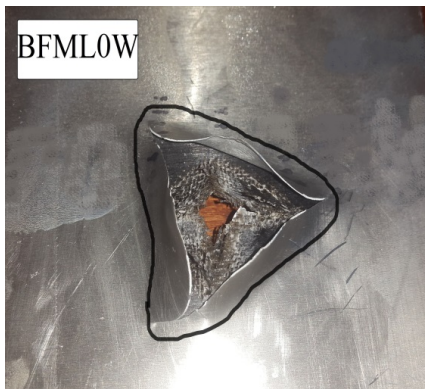
شکل ۹- مساحت تخریب نمونه BFML0W
