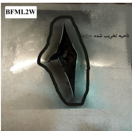
شکل ۱۰- مساحت تخریب نمونه BFML2W
