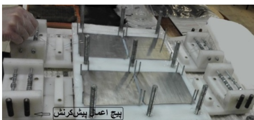
شکل ۱- فیکسچر ساخت نمونه و مکانیزم اعمال پیش‌کرنش
