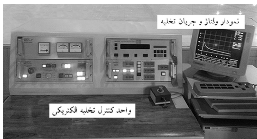
شکل ۲- تجهیزات فرایند شکل‌دهی الکتروهیدرولیکی
