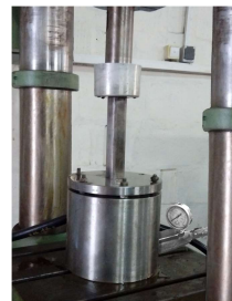
شکل ۲- مجموعه قالب نصب شده بر روی دستگاه آزمایش
