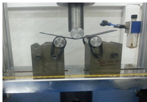
شکل ۲- نمونه کامپوزیتی تحت بارگذاری خمش سه نقطه‌ای
