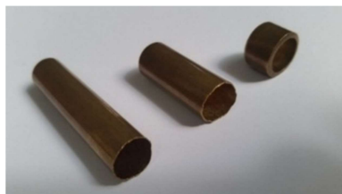
شکل ۴- نمونه‌هایی از قطعات کشش عمیق و اتوکاری شده در سه مرحله
