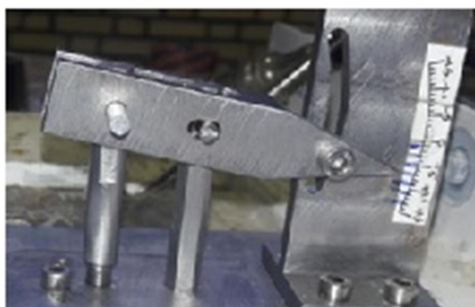
شکل ۴- مکانیزم زاویه حمله مدل اگارد-بی
