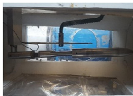
شکل ۳- نمایی از مدل بال و بدنه اگارد- بی در اتاق آزمون
