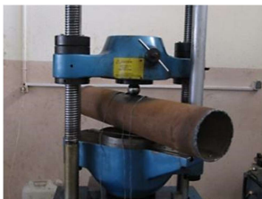
شکل ۳- شرایط مرزی برای لوله فولادی API XB [۱۵].
