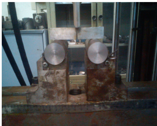
شکل ۷- آزمون خمش سه نقطه‌ای بر روی نمونه‌ای از فولاد هدفمند باینیتی
