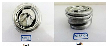
شکل ۶- نحوه چین خوردگی نمونه O_1IF_0L_00 (الف) نمای روبرو. (ب) نمای بالا
