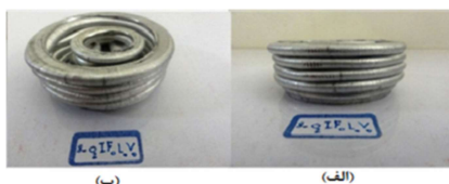
شکل ۷- نحوه چین خوردگی نمونه O_2IF_0L_00 (الف) نمای روبرو. (ب) نمای بالا.
