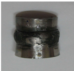
شکل ۲- نمونه دریافت شده از لوله ترک خورده
