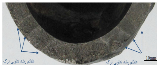
شکل ۷- علائم رشد تناوبی ترک بر روی سطح شکست
