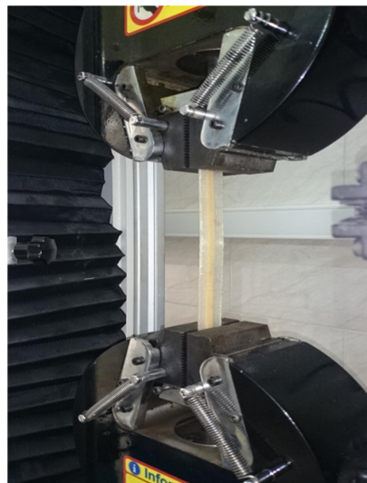
شکل ۳- نحوه انجام آزمون کشش بر روی نمونه‌ی کامپوزیتی
