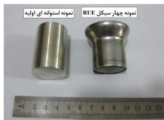
شکل ۴- نمونه‌های استوانه‌ای اولیه و چهار سیکل RUE آلیاژ ۷۰۷۵
