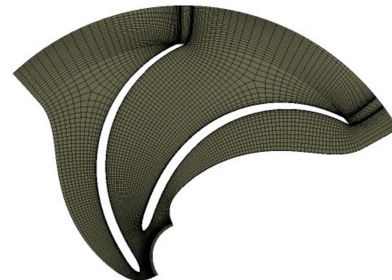
شکل ۱۹- سطح مقطع پروانه با ضخامت ۵ میلی‌متر در ارتفاع متوسط
