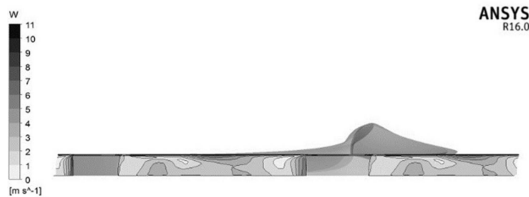
شکل ۱۶- کانتور سرعت نسبی در خروجی پمپ برای زاویه ۵ درجه
