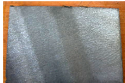
شکل ۴- تصویر میکروسکوپی از مقطع آماده سازی شده نمونه "الف". محلول اچ: نایتال ۱۰٪
