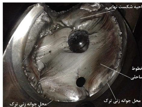
شکل ۳- سطح شکست در محل اتصال محور لنگ به لنگ بر روی لنگ
