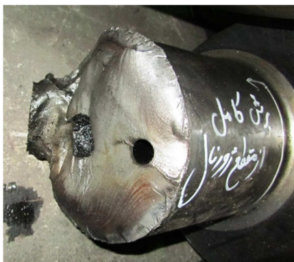
شکل ۲- سطح شکست در محل اتصال محور لنگ به لنگ بر روی محور لنگ
