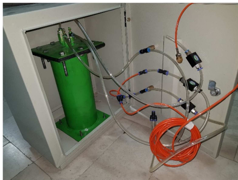
شکل ۱- (الف) مدار نیوماتیک سیستم حداقل مقدار روانکار استفاده شده (ب) دستگاه روانکار کمینه ساخته شده
