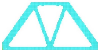
شکل ۵- توپولوژی قطعی بهینه برای اعمال دو بار در زمان مختلف و استفاده از ضرایب وزنی (الف) مرجع [۳]
