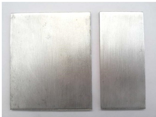
شکل ۱- نمونه های آماده سازی شده جهت انجام جوشکاری
