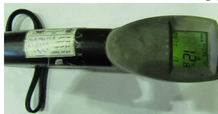
شکل ۳- دوربین گرما سنج نقطه ای لیزری مدل Raytec-Rauenger (ST) مورد استفاده در این پژوهش
