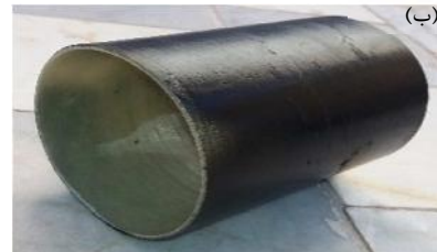
شکل ۱- (الف) مدل طراحی شده و (ب) نمونه ماده مرکب ساخته شده با عیب الیاف خشک
