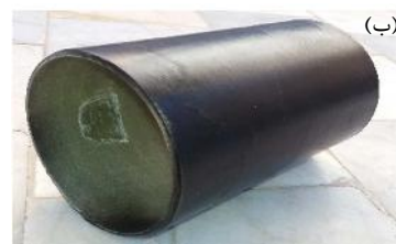
شکل ۲- (الف) مدل طراحی شده و (ب) نمونه ماده مرکب ساخته شده با عیب جدایش بین لایه‌ای
