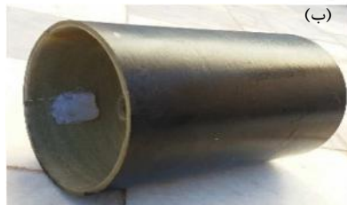
شکل ۳- (الف) مدل طراحی شده و (ب) نمونه ماده مرکب ساخته شده با عیب نفوذ مواد ناخواسته
