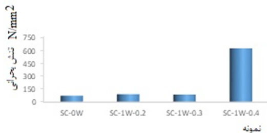
شکل ۶- نمودار مقایسه تنش بحرانی نمونه‌های ۱ سیم با نمونه شاهد
