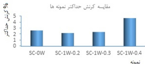
شکل ۷- نمودار مقایسه کرنش حداکثر نمونه‌های ۱ سیم با نمونه شاهد
