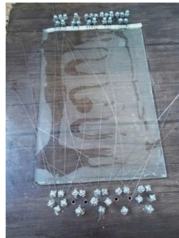
شکل ۱- نمایی از فیکسچر ساخت و نحوه بستن سیم‌ها
