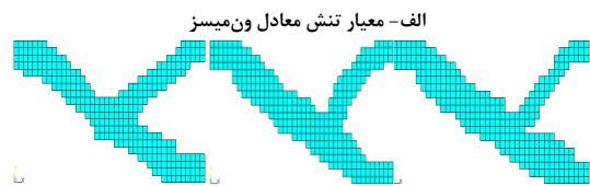
الف- معیار تنش معادل ون میسر ب- ۱- روش BESO و ب- ۲- روش BESO و ب- ۳- روش ESO نسبت حذف و اضافه و اضافه متفاوت یکسان ب- معیار سختی
