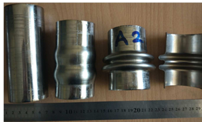
شکل ۳- مراحل مختلف تولید بیلوز فلزی در کار تجربی (از چپ به راست)
