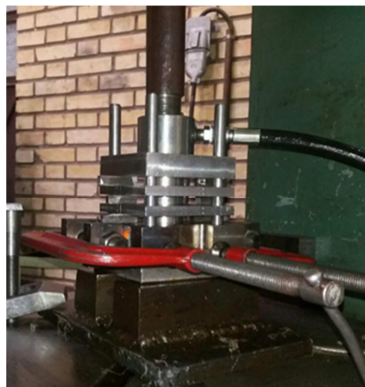
شکل ۲- مجموعه قالب نصب شده بر روی پرس هیدرولیک
