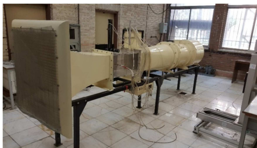
شکل ۲- تونل باد مدار باز مکنده موضوع مقاله D = 30\text{ cm}
