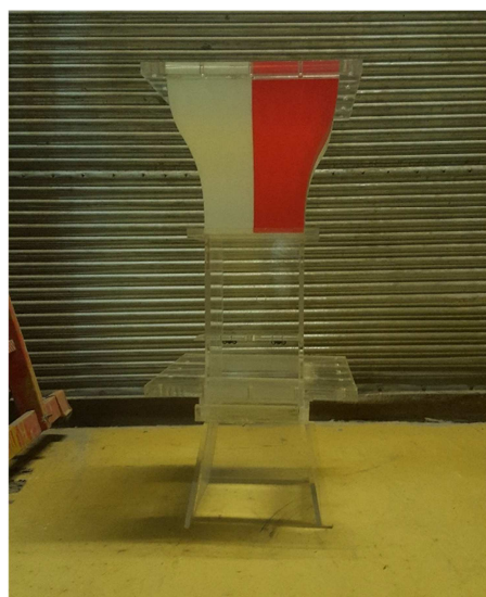
شکل ۶- مجموعه نازل، اتاق آزمون و بخش‌کن ساخته شده خارج از تونل باد، به صورت عمودی
