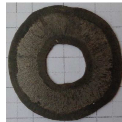
شکل ۲- حلقه فشرده شده در آزمون فشار حلقه (مناطق تیره‌تر، در نتیجه خم شدن دیواره‌های جانبی حلقه به وجد آمده‌اند) [۴]
