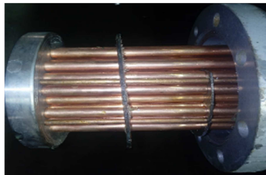
شکل ۵- طرحواره اجزای داخلی مبادله‌کن گرمایی
