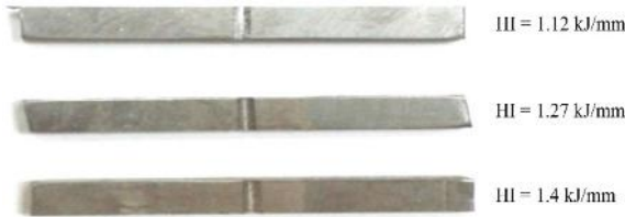
شکل ۸- نمونه‌های آزمون ضربه اتصالات جوشکاری شده در گرماهای ورودی مختلف
