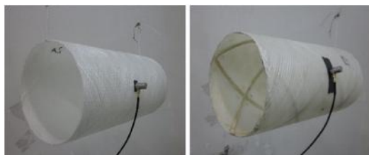
شکل ۶- نمونه‌های ساده و مشبک آماده شده برای تست مودال
