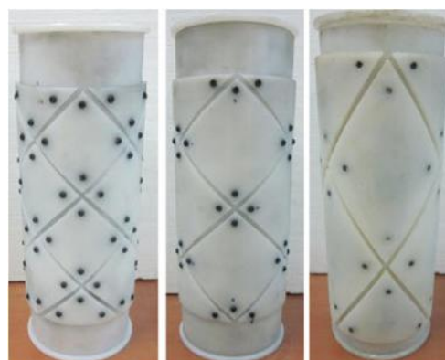
شکل ۲- قالب‌های پلی‌ایتیلنی ساخت نمونه‌ها
