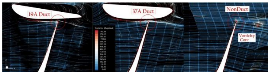
شکل ۱۶- خطوط جریان با ۱۸۰۰ بر دار، رنگ‌شده به‌وسیله گردابه 1/s در ضریب پیشروی ۰/۵ و موقعیت Y=0
