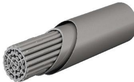
شکل ۱- نمایی از بسته سوخت درون یک لوله تحت فشار که همگی درون لوله دیگری به نام Calandria قرار گرفته اند [۱۱].
