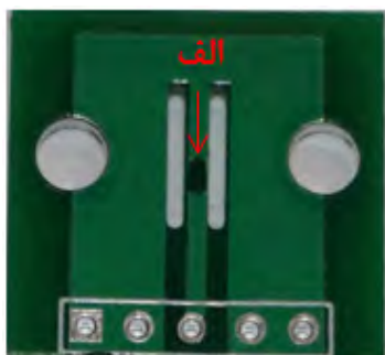
شکل ۲: الکتروده آماده شده دارای مکان مشخصی برای قراردادن اکسید فلز است.
