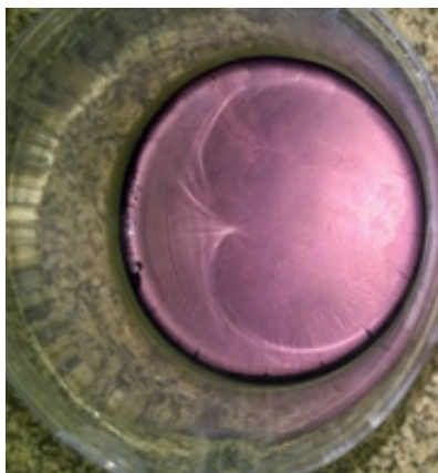
شکل ۳: مراحل روش آب گرم برای استخراج ایندیگو از سمت راست به ترتیب سرد کردن سریع و سمه، اکسیژن دهی و تشکیل لایه نقره ای آبی ایندیگو پس از گذشت هفت روز
