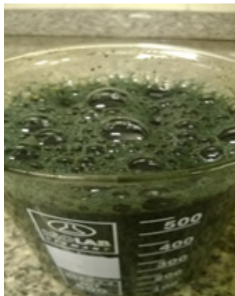
شکل ۳: مراحل روش آب گرم برای استخراج ایندیگو از سمت راست به ترتیب سرد کردن سریع و سمه، اکسیژن دهی و تشکیل لایه نقره ای آبی ایندیگو پس از گذشت هفت روز
