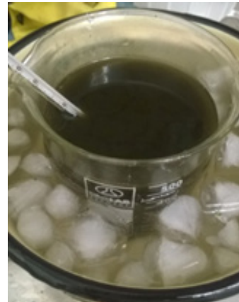
شکل ۳: مراحل روش آب گرم برای استخراج ایندیگو از سمت راست به ترتیب سرد کردن سریع و سمه، اکسیژن دهی و تشکیل لایه نقره ای آبی ایندیگو پس از گذشت هفت روز
