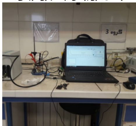
شکل ۲: تصویر ستاپ تست خوردگی شرکت اتولب
