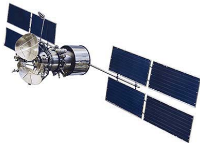
شکل ۲۰- نصب صفحات به صورت موازی روی ماهواره [۴۹].
