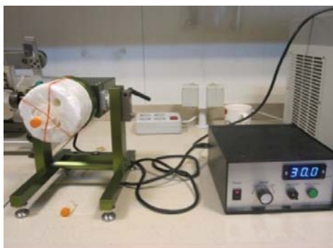
شکل ۱- نحوه سوار کردن کرایوتیوپ حاوی نمونه روی دستگاه.
