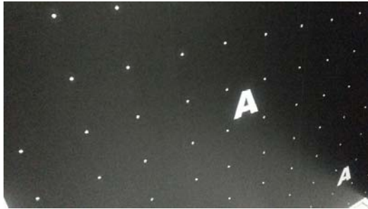
شکل (۶): نصب نقاط بازتاباننده بر روی صفحات و نشانه‌گذاری آنها با علائم و حروف.
