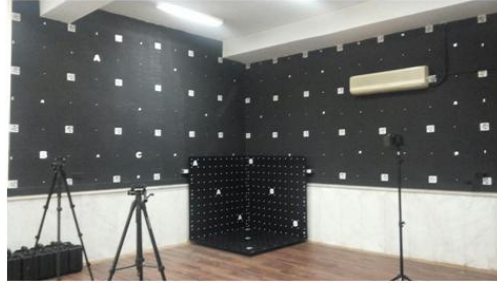
شکل (۸): شمای کلی دیوارهای محل استقرار تست فیلد بعد از نصب نقاط هدف کددار.
