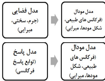
شکل (۲): روند تبدیل مدل در حوزه عددی (شکل بالا) و تجربی (شکل پایین).
