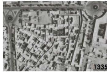
شکل ۵ نحوه استقرار بافت مترکام و ابنیه متصل بهم جهت کاهش تبادل حرارتی در بافت سنتی تبریز [۲۷].
