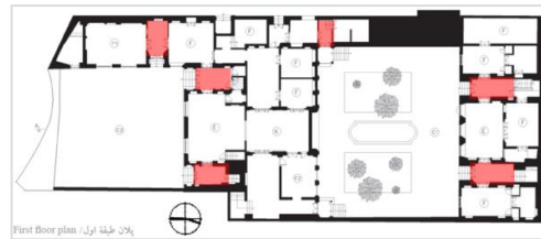
شکل ۹ دهلیز و دالان در خانه مجتهدی؛ حایل حرارتی برای جلوگیری از نفوذ بادهای سرد زمستان [۲۷].
