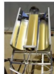
شکل ۲۲ دستگاه ضد عفونی آب با پرتوی فرابنفش [۳۷]
