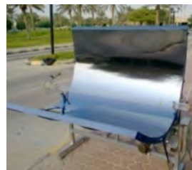
شکل ۲۵ راکتور نوری پلکانی و سهموی برای ضدعفونی آب [۴۰]
