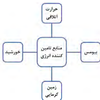
شکل ۲ منابع تامین کننده انرژی برای سیکل رانکین ارگانیک
