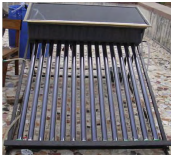
شکل ۱۲ استفاده از وکیوم تیوب جهت افزایش آب داخل دستگاه [۱۲]
