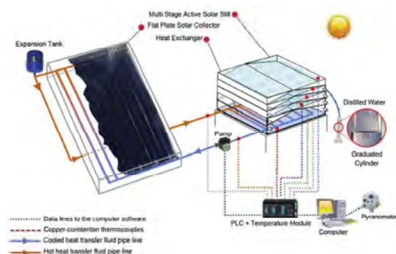
شکل ۸ اضافه کردن کلکتور تخت به دستگاه مدل چند طبقه [۸]
