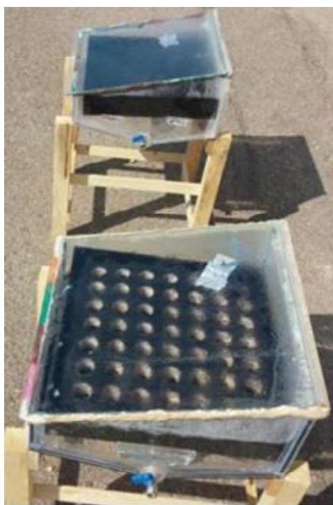
شکل ۲ استفاده از لاستیک اسفنجی متخلخل در کف دستگاه [۲]
