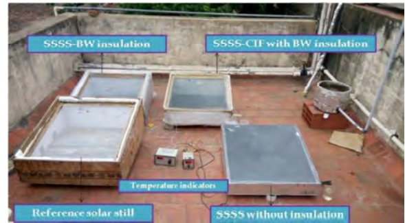
شکل ۳ استفاده از فوم اشباع کربن و همچنین عایق بندی با بابل رپ [۳]
