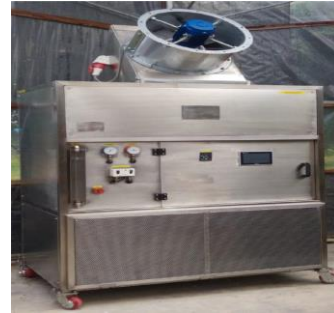
شکل ۱۲ پمپ حرارتی استفاده شده در خشک‌کن گلخانه
