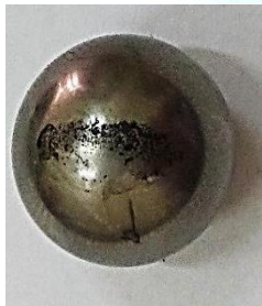
شکل ۱۱. خرابی‌های مشاهده شده بر روی اجزاء یاتاقان و مشاهده علائم آلودگی روانکار
