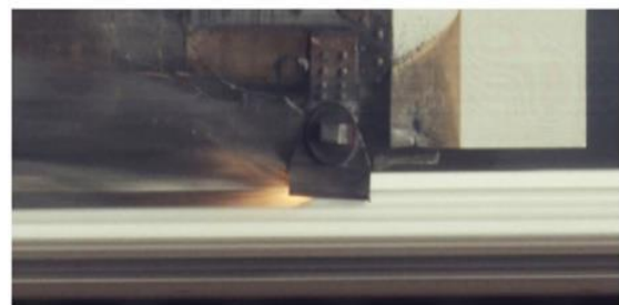
شکل ۹. نمونه‌ای از برخورد کفشک با ریل [۳۱]
