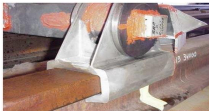
شکل ۶. نحوه اتصال ریل به کفشک [۲۸]
