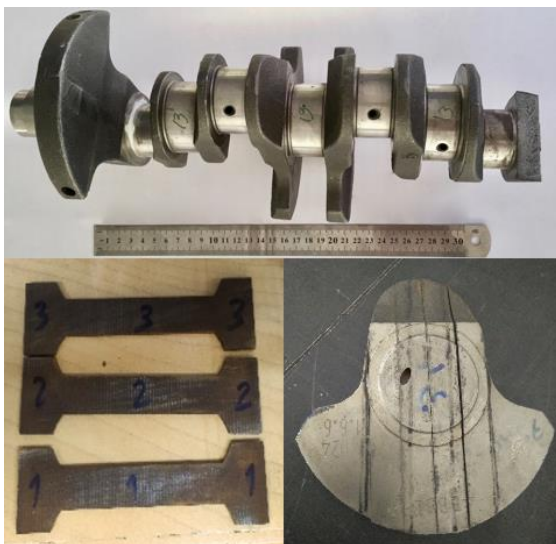
شکل ۱. استخراج نمونه‌های استاندارد از داخل وب میل‌لنگ
