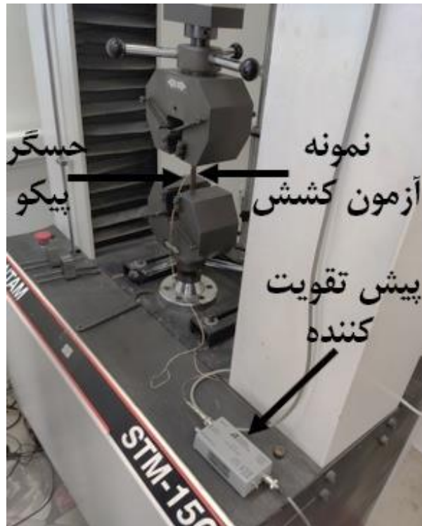
شکل ۳. دستگاه آزمون کشش یونیورسال سنتام مدل STM-150
