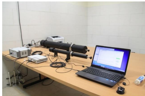
شکل ۵. نمایی از دستگاه امپدانس تیوب مستقر در آزمایشگاه "اندازه‌گیری خواص آکوستیکی مواد" در دانشگاه صنعتی امیرکبیر.
