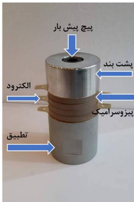
شکل ۲. اجزای اصلی مبدل پیزوالکتریک فراصوتی
