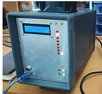
شکل ۱. منبع تغذیه‌ی فراصوت (توان ۱/۵ کیلووات و فرکانس
