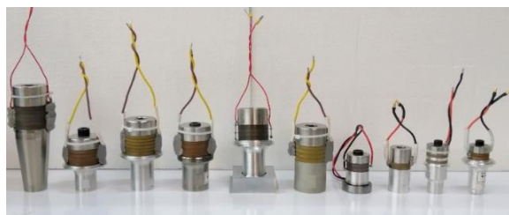
شکل ۳. طرح‌های مختلف مبدل پیزوالکتریک فراصوتی
