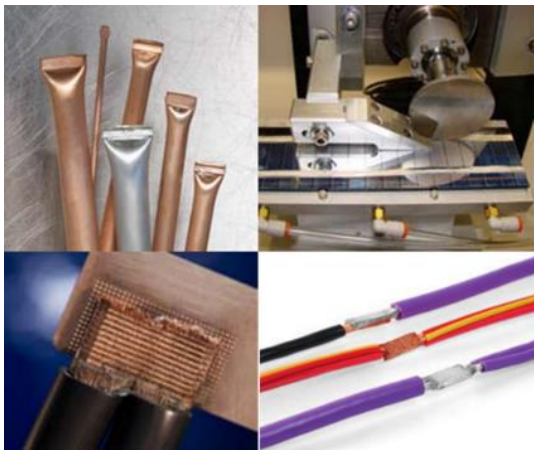
شکل ۲۱. اتصالات ایجاد شده توسط جوشکاری فراصوتی فلزات
