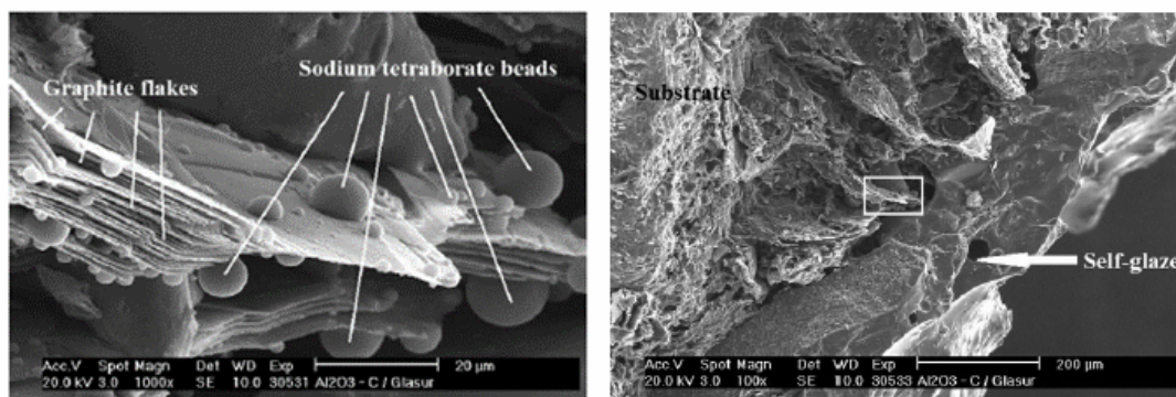
شکل ۶- تصویر میکروسکوپ الکترونی از چپ: سطح لعاب و راست: فصل مشترک زیر لایه و لعاب بعد از اکسیداسیون [۳]
