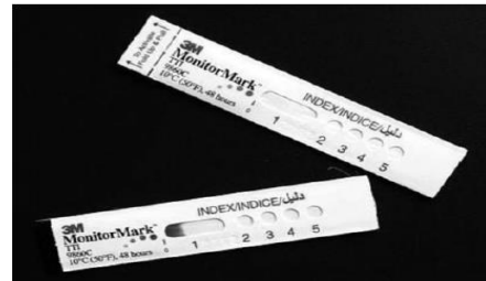
شکل ۵- MonitorMark™ نوع دیگری از نشان گر زمان-دما
