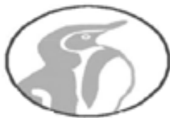
شکل ۴- جوهر نقطه ای ترموکرومی، زمانی که پنگوئن در نشان گر دیده شود، نشان دهنده این است که دما در محدوده صحیحی قرار دارد.
