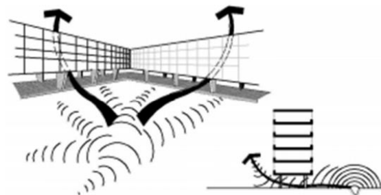
شکل (۳): شکل مناسب نمای ساختمان برای کاهش ریزش آوار به محیط (میخت بیست یکم مقررات ملی ساختمان).
