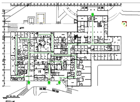
شکل (۱۱): نقشه خروج ساختمان در طبقه همکف.
